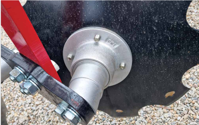
O-prsten + Limeni poklopac + RS zaptivka/ Kasetna zaptivka + Kovani poklopac
