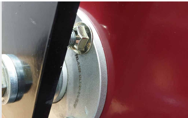
Limeni poklopac + Kasetna zaptivka + RS zaptivka + Kasetna zaptivka + Kovani poklopac
