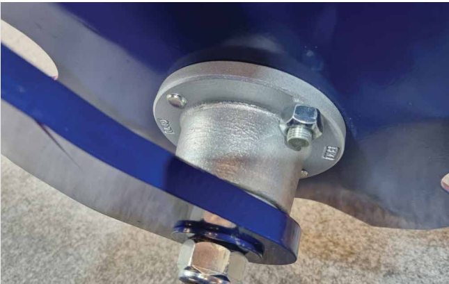
O-prsten + Limeni poklopac + RS zaptivka/RS zaptivka + Kasetna zaptivka + Kovani poklopac
